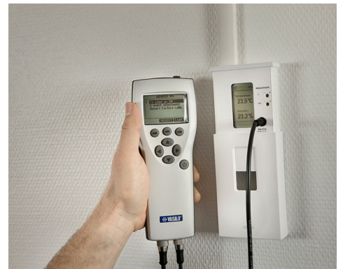
使用 HM70 手持式仪表进行现场校准
